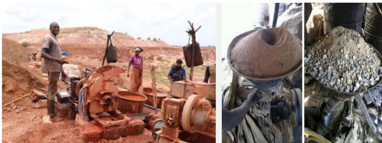
*Figure 7 : Broyage humide (gauche) et broyage à sec (droite)
