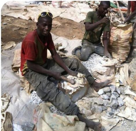
Figure 6 : Concassage des roches (AFFESSI et al., 2016)
