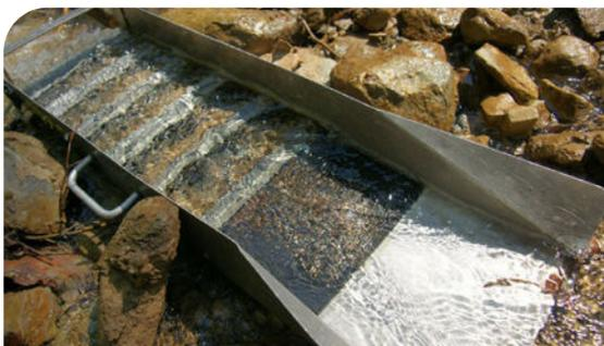
Figure 4 : Traitement des sédiments alluvionnaires pour la récupération de l'or (MAY, 2007)
