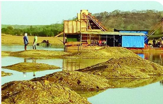
Figure 3 : Résidus du dragage après extraction du minerai (MALIJET, 2023)
