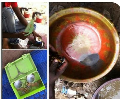
*Figure 8 : Traitement du minerai au mercure (AFFESSI et al., 2016)*
